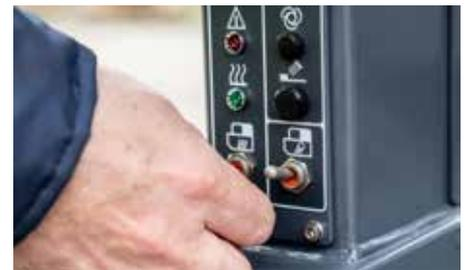
Información clara con controles integrados. Sea rápido y conozca el estado de la máquina con interruptores directamente visibles que incluyen información clara. Ahorre tiempo y automatice el movimiento de la regla sobre la marcha activando el MatTracker directamente desde la posición del operador de la regla. Optimice los recursos necesarios y encienda y apague la calefacción del escudo lateral con un interruptor específico y reciba directamente el estado de la calefacción.
