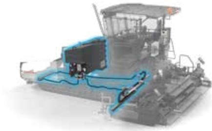
La unidad de pulverización se activa y controla fácilmente mediante una pantalla táctil de 7", robusta y fácil de usar, situada directamente en el panel de control. Esto permite al operador supervisar y ajustar sin esfuerzo el sistema de pulverización.
